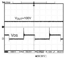
Fig. 5 VDS Waveform
