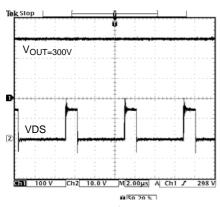
Fig. 6 VDS Waveform
