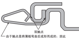
由于触点是薄板弯曲后形成的，因此触点部具有充分的弹簧特性，是耐拧绞、耐落下冲击的构造。
